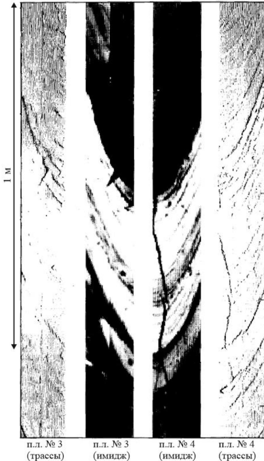
Рисунок 1.2 – Результаты измерений пластовым микросканером FMS в монтерейской свите (Калифорния, США) [Formation Imaging ..., 1986]. Записанные сигналы представлены как в виде имиджа (в центре), так и в виде отдельных трасс (по краям). На имидже прослеживаются наклонные границы слоёв, трещины и каверны
